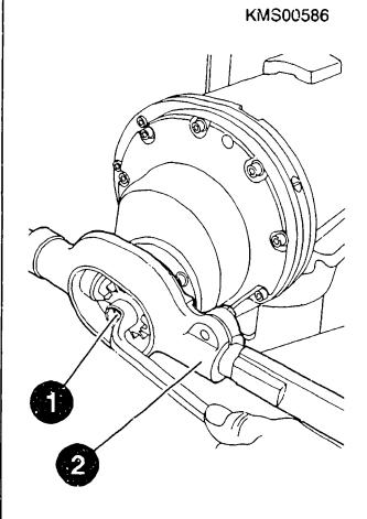
DISASSEMBLING REDUCTION GEAR (TYPE TF 0 001 608 .../... 611)
